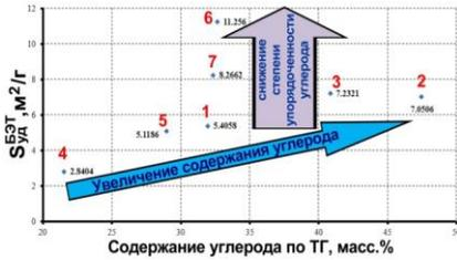
**Рисунок 6** – Влияние содержания углерода в составе шунгита и степени его упорядоченности на удельную поверхность порошков
